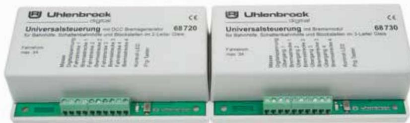
Alle Steuerungsaufgaben können mit zusätzlichen Modulen erweitert werden. Die Bahnhofsteuerung kann bis zu 12 Bahnhofsgleise und ein Umfahrgleis verwalten. Alle zur Bahnhofsteuerung notwendigen Fahrstraßen werden als Schaltfolgen von Magnetartikeln im Modul gespeichert und vom Modul ausgelöst und geschaltet. Es sind keine weiteren Geräte zum Schalten der Fahrstraßen notwendig.
